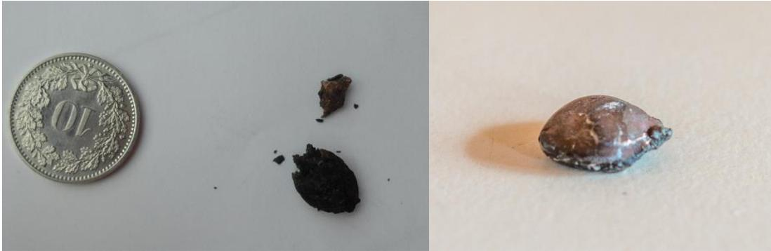
*Production de Cuivre 2017 à partir de la chalcopryrite de la mine de La Lée (Zinal, Suisse).*
